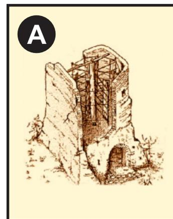
En Europe, les premiers moulins à vent apparaissent dans le courant du 12<sup>e</sup> siècle. Ce sont des moulins à axe horizontal que les meuniers peuvent orienter face au vent. Ils comportent quatre ailes montées sur une charpente en bois et tournant autour d'un pivot central.
