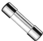
Le principe du fusible est le suivant : lorsqu'un courant traverse un fil conducteur, ce dernier chauffe (à cause des frottements dus aux déplacements des électrons). Pour un même conducteur, plus le courant est important, plus l'échauffement est important. Si l'on veut limiter cet échauffement il faut insérer dans le circuit, un interrupteur qui ouvrira le circuit en cas de surchauffe. Le fusible joue ce rôle.
