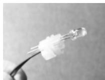
**Pour fixer la LED\*** dans le circuit, tu peux utiliser le petit support en plastique blanc (ou noir) attaché à deux fils de connexion (1 rouge, 1 noir). Tu dois enfoncer chacun des deux pieds de cette LED dans chacun des deux trous prévus. Les pieds se trouvent ainsi parallèles aux fils de raccordement (voir photo ci-contre).
