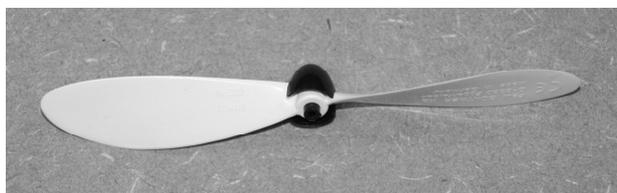
Quelle que soit la face qui reçoit l'air, l'hélice tourne toujours dans le **même sens**. Les constructeurs vendent des hélices qui tournent dans le sens contraire du sens de rotation des aiguilles d'une montre (on appelle ce sens le *sens anti-horlogique*).
