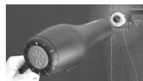
**Si** tu construis toi-même ton hélice, la LED ne brillera pas en soufflant toi-même sur l'hélice. Tu dois absolument utiliser la plus grande vitesse du sèche-cheveux.
