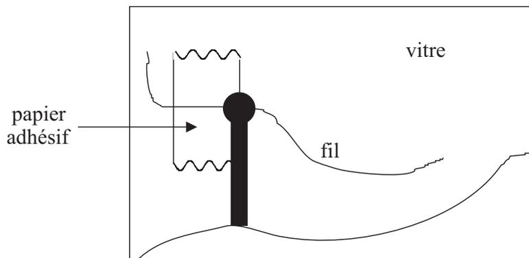
Fig. 17 : Fixation des fils
