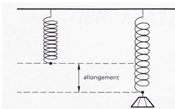
Lorsqu'aucune masse n'est suspendue, le ressort mesure 15cm.
