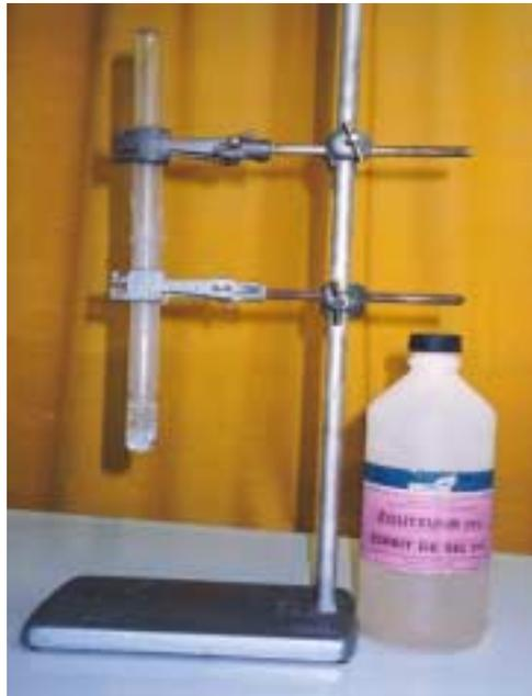
Dans une éprouvette (A) remplie au 1/3 d'esprit de sel (maintenue par une pince accrochée à un statif), plonge la paille de fer et recueille le gaz dans une éprouvette (B) située juste au dessus de l'éprouvette (A), comme indiqué sur la photo.
