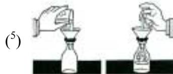
Remarque : une manière de faire sortir l'air de la bouteille sans utiliser de paille consiste à percer un trou dans le haut de la bouteille. A ce moment, l'eau coule à nouveau de l'entonnoir.
