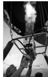
Le **brûleur** permet au pilote de chauffer l'air emprisonné dans l'enveloppe.
