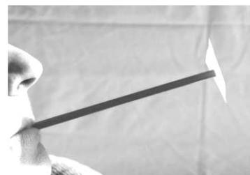
Une fois l'air contenu dans la paille aspiré, la pression à l'intérieur de celle-ci diminue. La pression atmosphérique devient supérieure à celle qui est dans la paille. C'est cette différence de pression qui maintient le morceau de carton « collé » à la paille.
