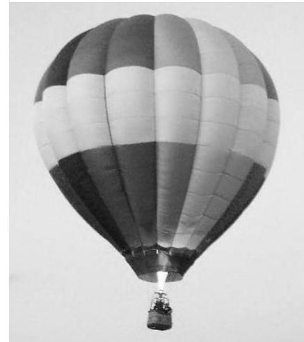
Pendant le vol, l'aérostier joue avec le brûleur : s'il donne un coup de gaz, il réchauffe l'air contenu dans l'enveloppe et permet ainsi au ballon de prendre de l'altitude. Si, au contraire, il laisse l'air se refroidir, l'engin descend. S'il s'avère que la descente doit être rapide, le pilote peut ouvrir une trappe qui se situe au sommet de l'enveloppe et permettre ainsi à l'air chaud de s'échapper.
