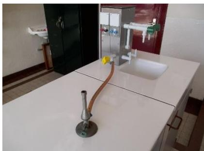
Il est à remarquer que certains becs Bunsen sont équipés d'une vanne de sécurité qui interrompt le passage du gaz en cas d'extinction de la flamme. Les vannes de sécurité doivent être homologuées et être livrées avec un certificat de conformité CE selon la directive 2009/142/EC.
