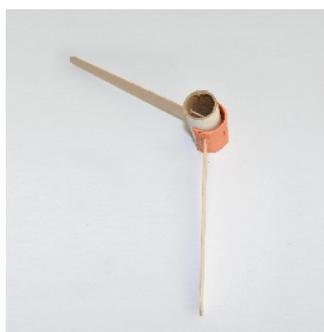
Cette articulation est composée d'un morceau de rouleau de papier aluminium en carton qui va pivoter dans un demi-cylindre réalisé en pâte à modeler. Le plus simple est de commencer par couper un morceau de rouleau de papier aluminium d'environ 3 cm de longueur. Ensuite, on le couvrira de film alimentaire et on modèlera le demi-cylindre
